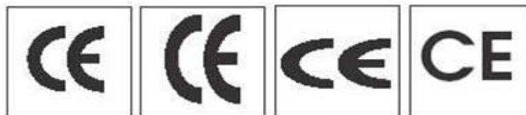
esempi di marcature non conformi
